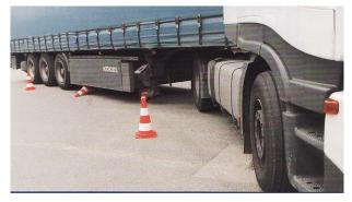
Während die gelenkten Vorderräder eine Kurve fahren, werden die Hinterräder von zwei- und mehrachsigen Fahrzeugen gezogen.
