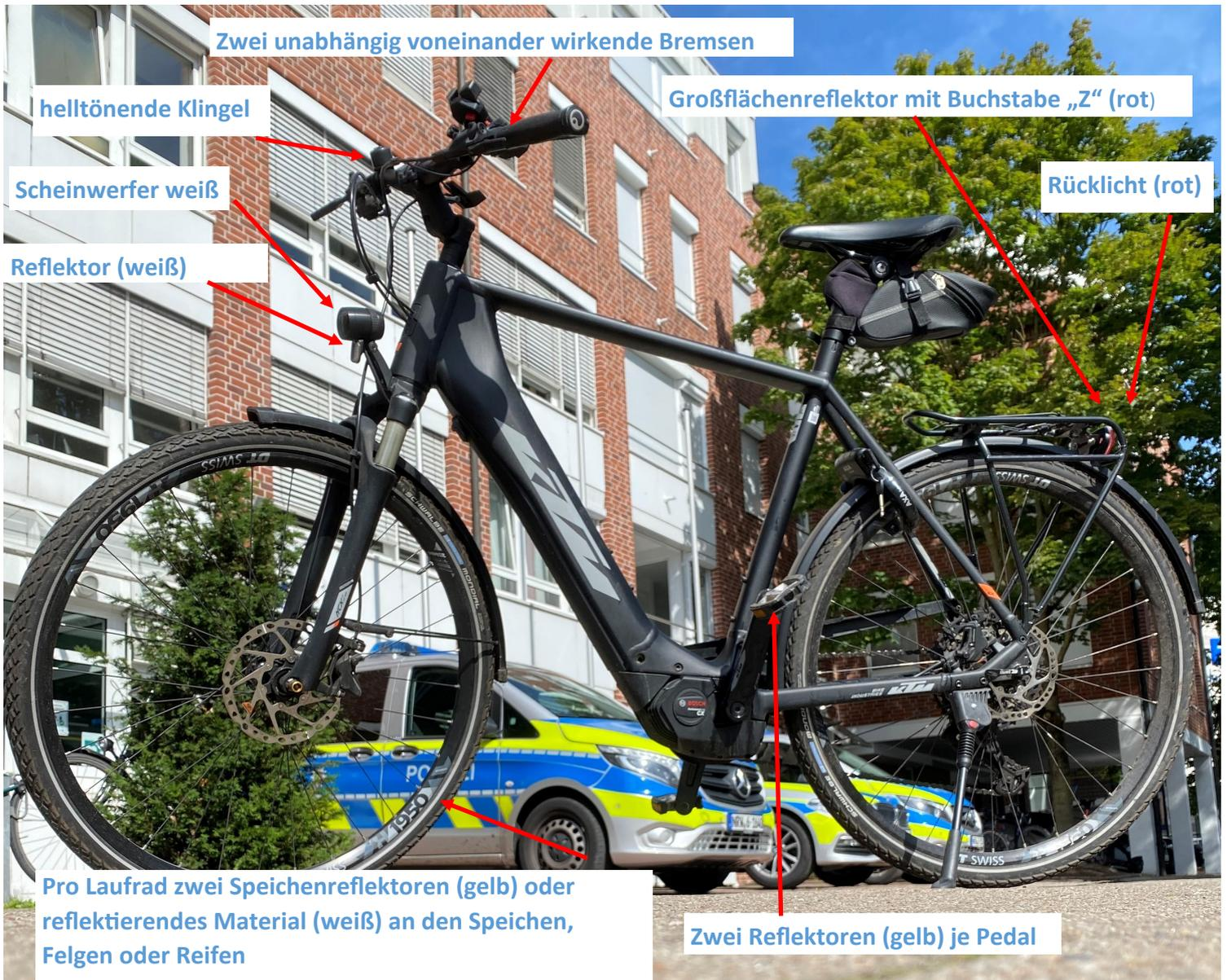
Zugelassene Reflektoren und Leuchten sind am Prüfzeichen zu erkennen (Wellenlinie, Buchstabe „K“ und einer Nummernfolge)
